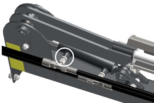
Рис. 178: Дроссель в цилиндре обрезчика пленки
