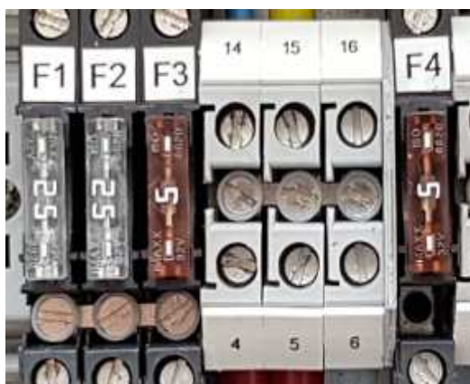
Рис. 155: Предохранители в распределительной коробке на дышле
