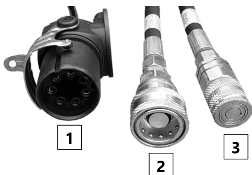
Рис. 111: Тормозная магистраль и дополнительная линия, штекер ABS
