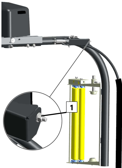
Рис. 180: Регулировка натяжения пружины
