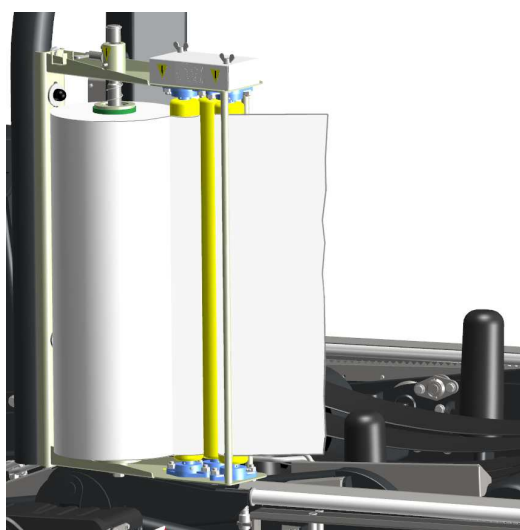
Рис. 131: Заправленная пленка для обмотки
