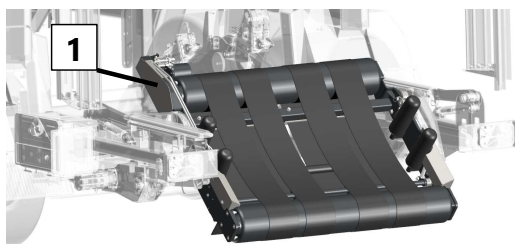
Рис. 202: Демонтаж защитной крышки
