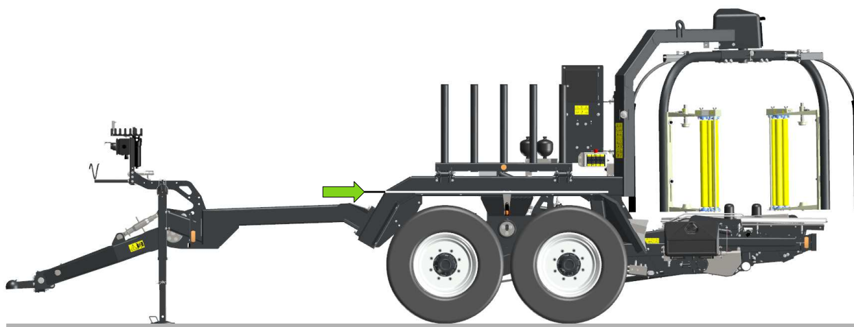
Рис. 103: Выравнивание машины в горизонтальном положении
