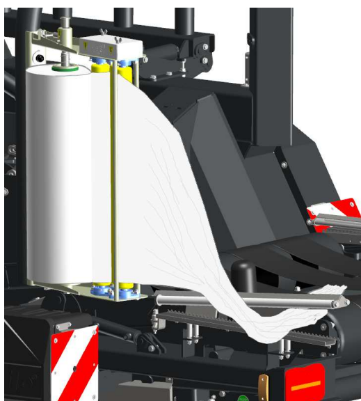
Рис. 134: Заправка пленки для обмотки
