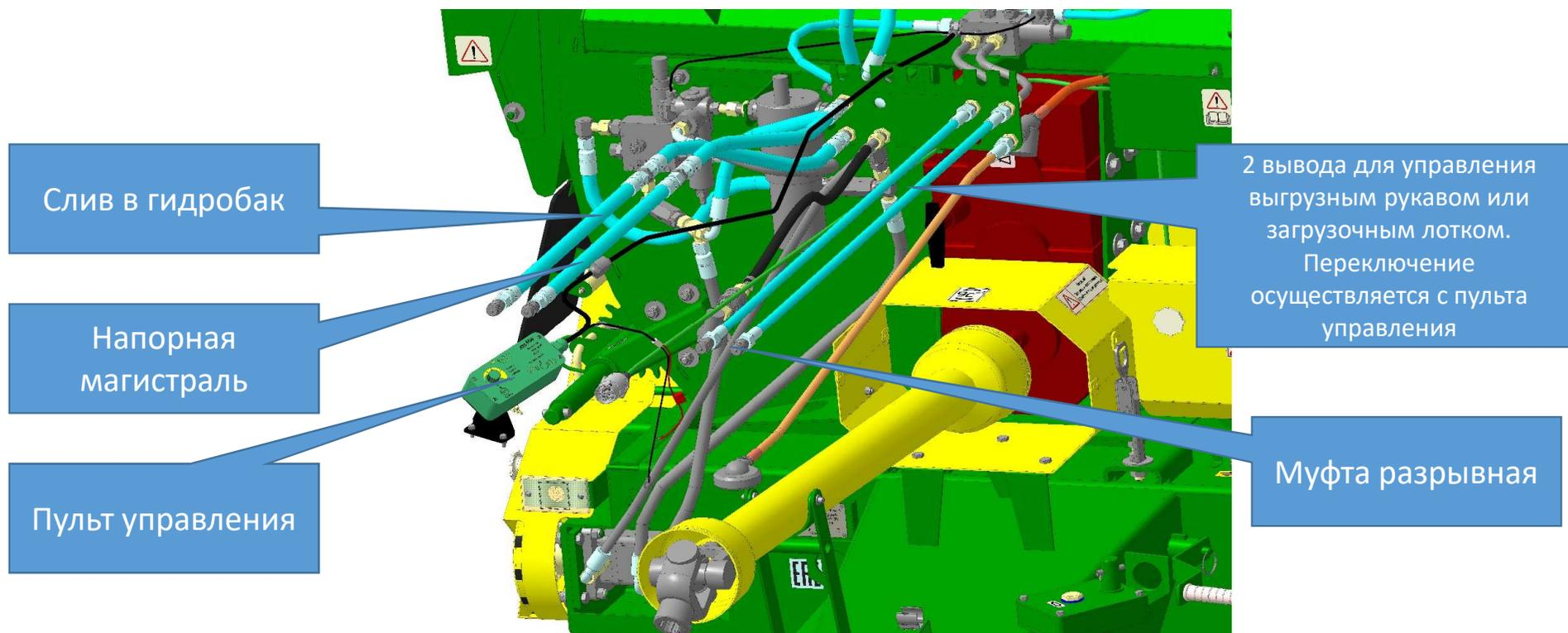
Установить на машину рукава высокого давления согласно рисунка. Проверить уровень масла в гидробаке трактора, при необходимости долить до верхнего уровня. Рукава, соединительные штуцера и муфты находятся в ЗИП.
