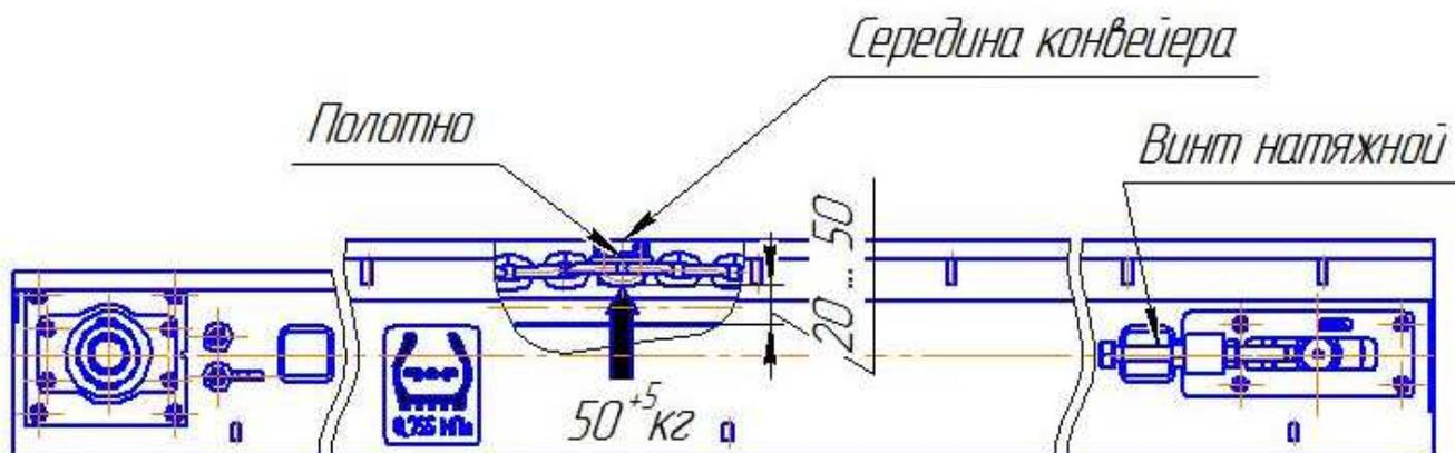
Для предотвращения выворачивания планок конвейера необходимо не реже 1 раза в неделю проверять натяжение полотна. Провисание должно составлять не более 50 мм при приложении усилия 50 кг к планке на середине конвейера. При необходимости провести регулировку при помощи винта натяжного.
