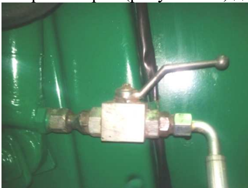
а) шаровой кран открыт (ручку гидрокрана установить вдоль гидромагистрали )
