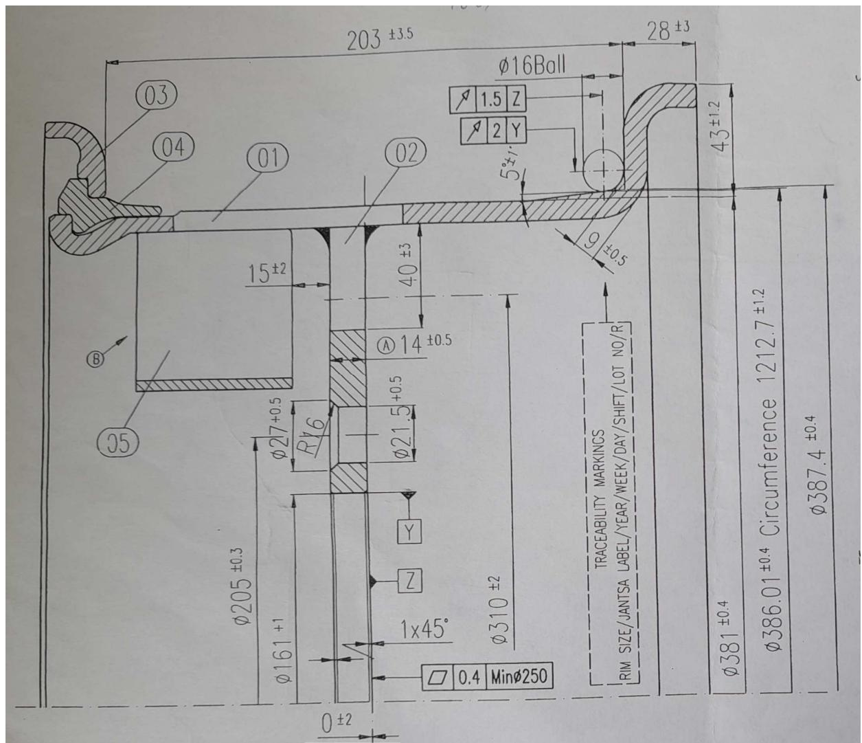
Рисунок - Колесо 8.0-15 ET0
