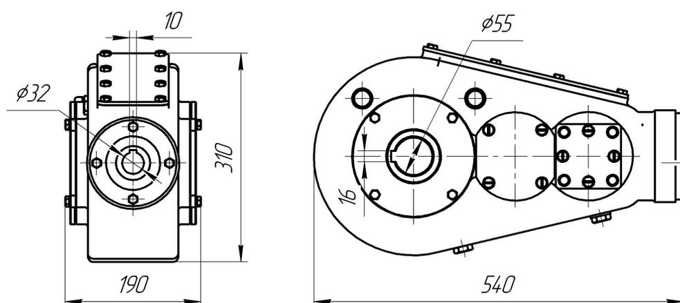
Рисунок – Габаритно-присоединительные размеры редуктора для машин по внесению твердых органических удобрений типа ПРТ-7А и МТТ-9
