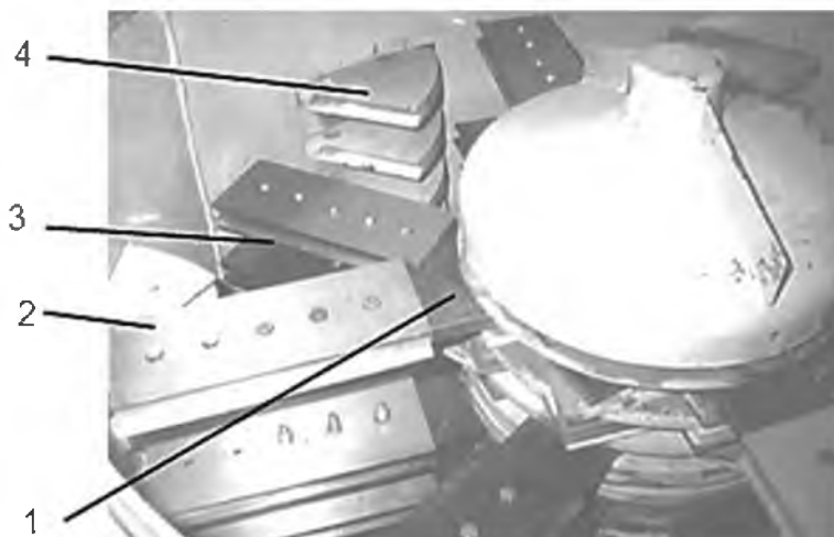
1 — державка; 2 — верхний нож; 3 — нижний нож; 4 — противорежущий элемент
