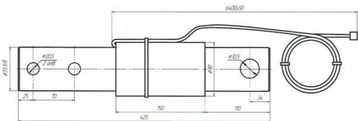
Рисунок – Габаритные размеры тензодатчика системы контроля
