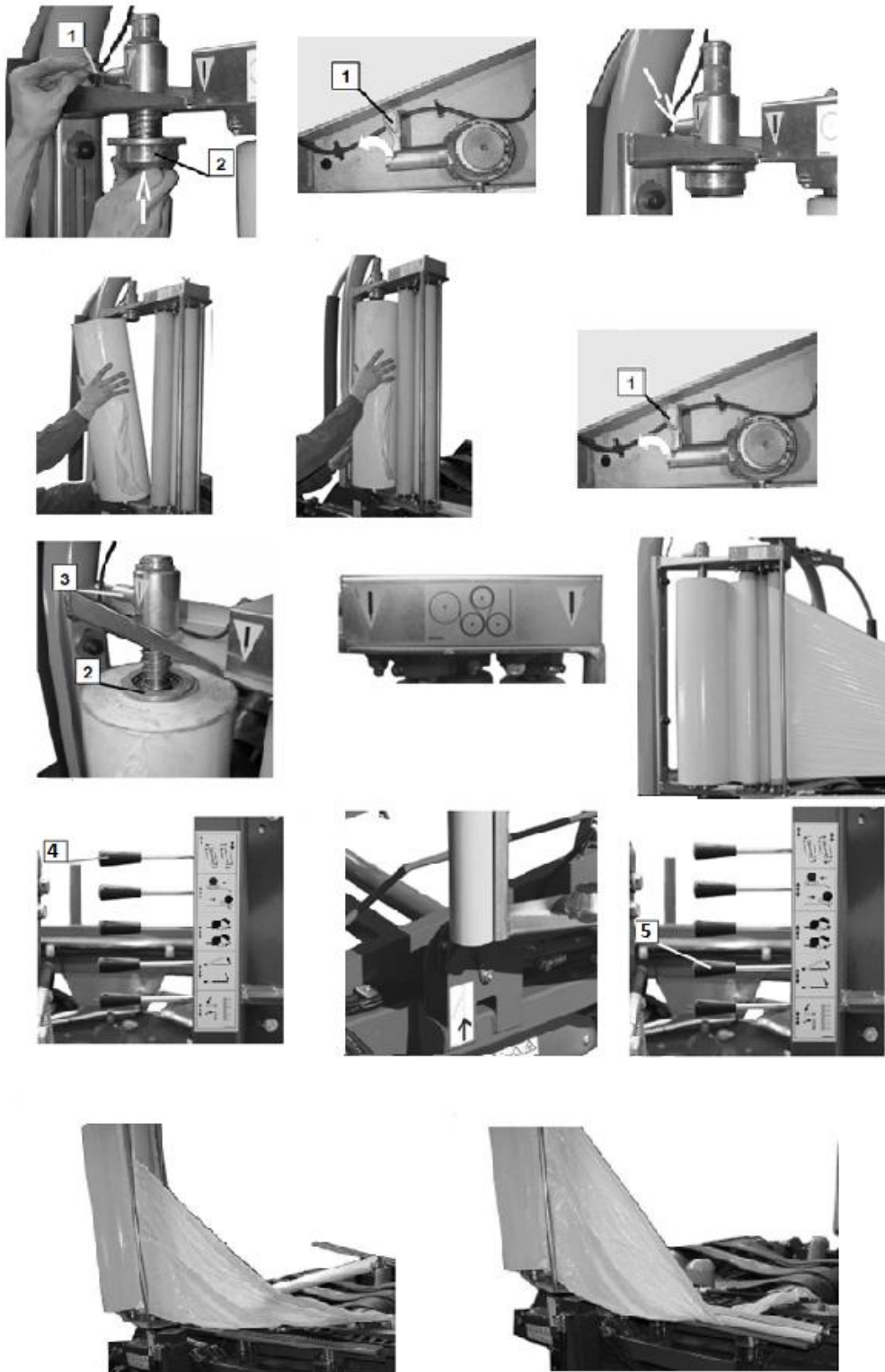
1 – болт блокировочный; 2 – держатель пленки; 3 – болт блокировочный 4 – рычаг заворачивания; 5 – рычаг обрезания
