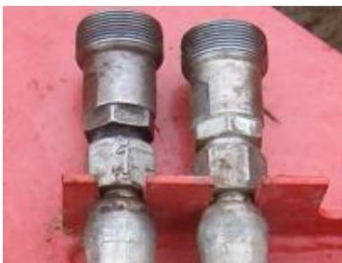
Рисунок 7 – Установка рукавов высокого давления при отсоединении оборачивателя от трактора
