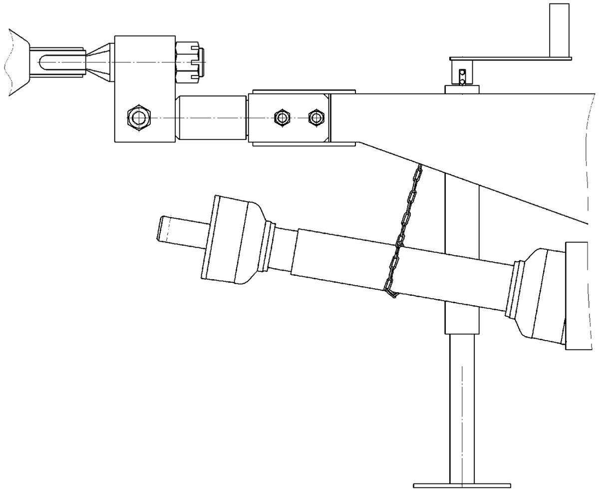
Рисунок 7.1 – Установка карданного вала на цепь
