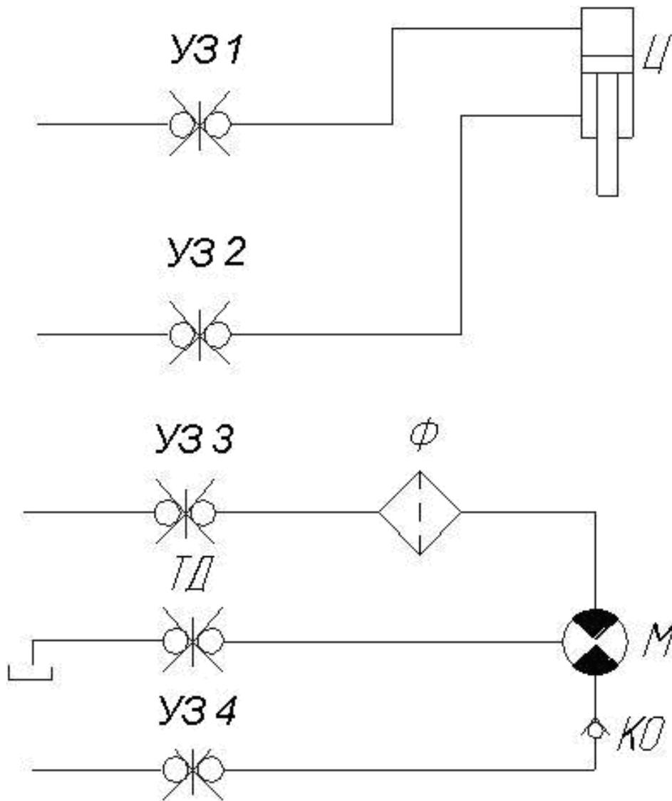
Ц – гидроцилиндр; М – гидромотор; Φ – фильтр; КО – клапан обратный;
