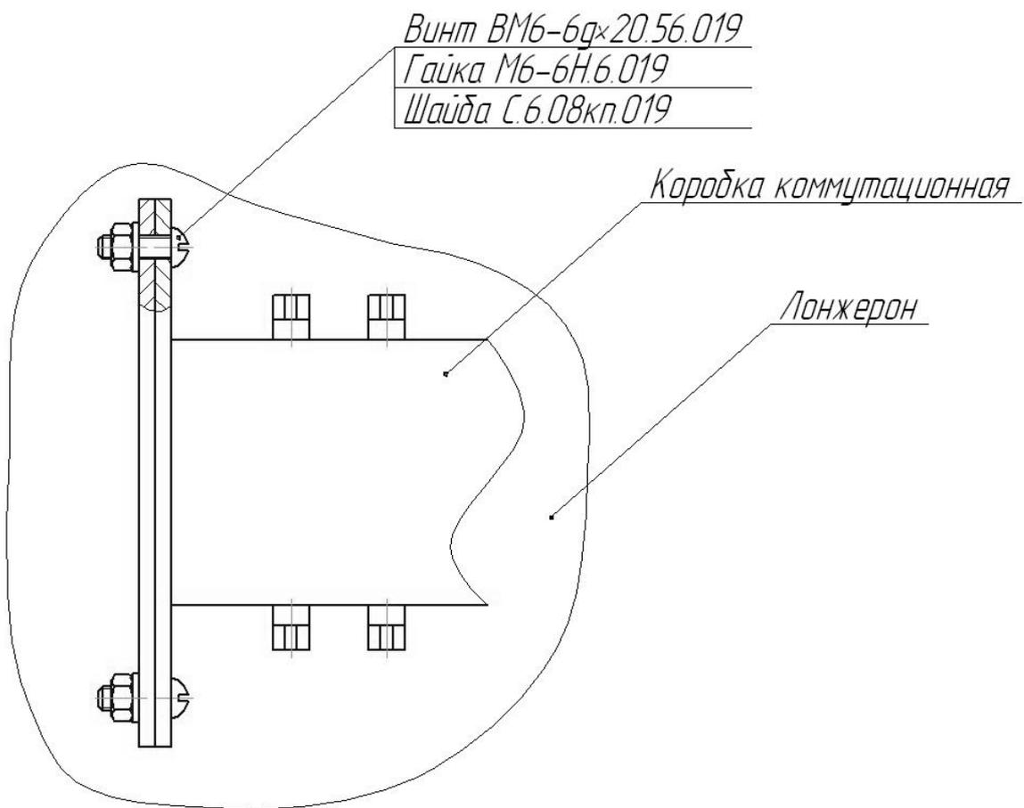
Рисунок 2.11 – Схема установки коробки коммутационной
