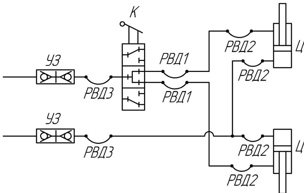
Ц– гидроцилиндр; УЗ – устройство запорное;
