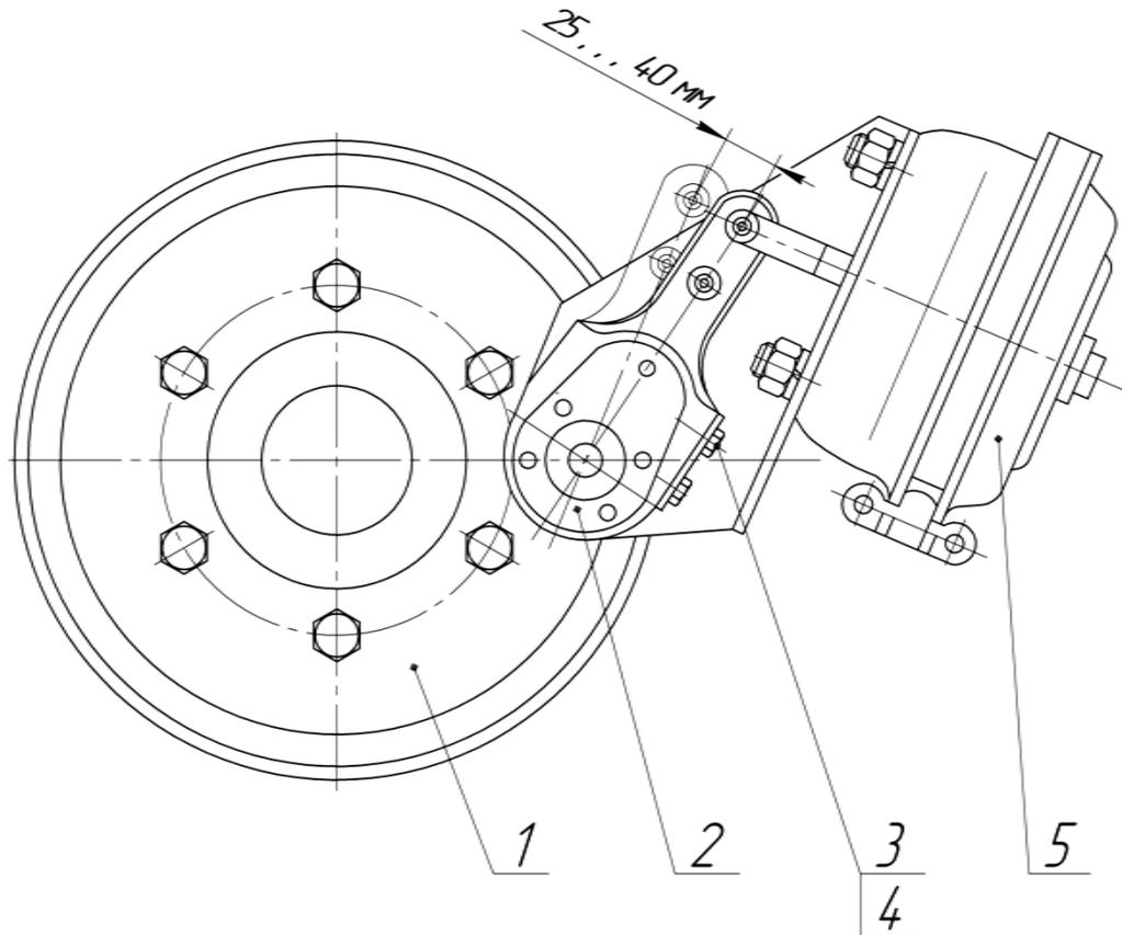
1 – колесо в сборе; 2 – рычаг регулировочный; 3 – винт стопорный; 4 – ось червяка; 5 – камера тормозная
