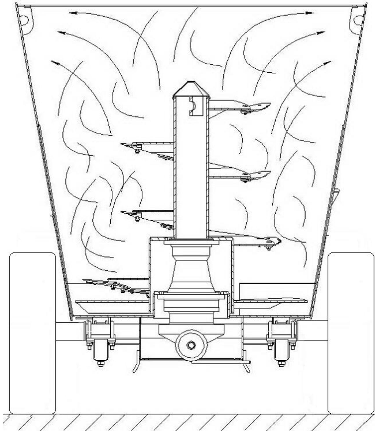
Рисунок 2.4 – Схема работы кормораздатчика
