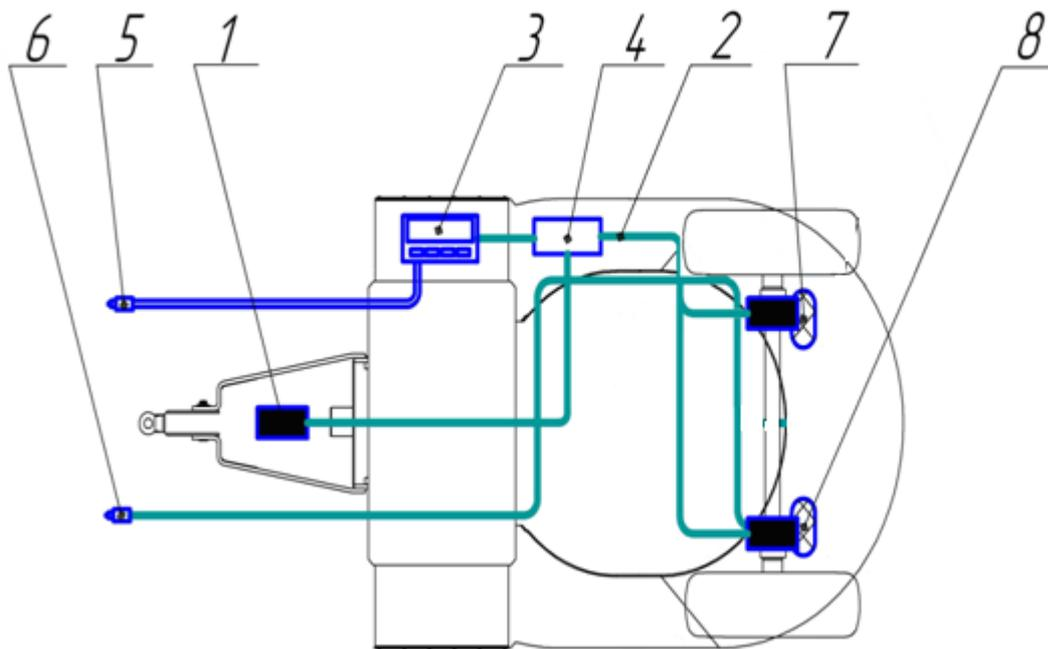
1 – датчик; 2 – система кабельной связи; 3 – индикатор цифровой;
