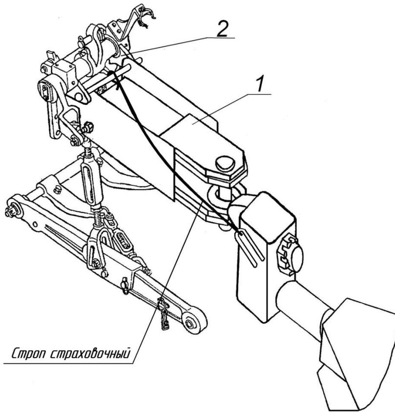
1 – сцепное устройство кормораздатчика; 2 – серьга навесного устройства трактора
