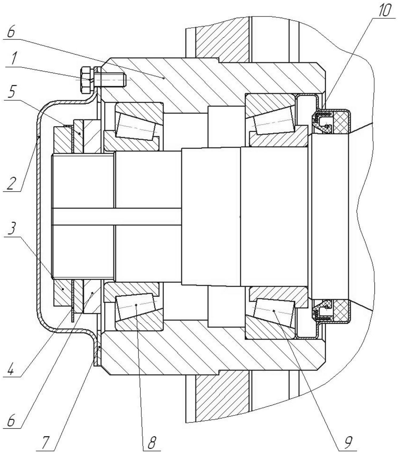
1 – болт; 2 – крышка; 3 – наружная гайка; 4 – стопорная шайба; 5 – замочная шайба; 6 – гайка; 7 – прокладка; 8,9 – подшипники; 10 – сальник
