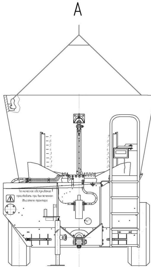
Рисунок 12.1 – Схема строповки кормораздатчика
