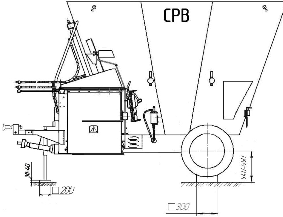
Рисунок 10.1 – Схема установки кормораздатчика на хранение
