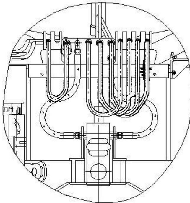
Рисунок 7.2 – Схема установки рукавов высокого давления
