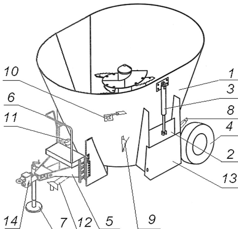
1 – бункер; 2 – шибер; 3 – гидравлическая система; 4 – мост с колесами; 5 – дышло; 6 – лестница; 7 – опора регулируемая; 8 – тормоз ручной стояночный; 9 – противорез; 10 – устройство для контроля количества загружаемых компонентов; 11 – система тормозная пневматическая; 12 – привод шнека; 13 – выгрузной лоток; 14 – сцепное устройство
