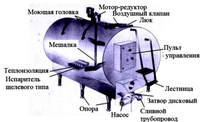
Рис. 2. Составные элементы резервуара-охладителя молока Г6-ОРМ-2500
